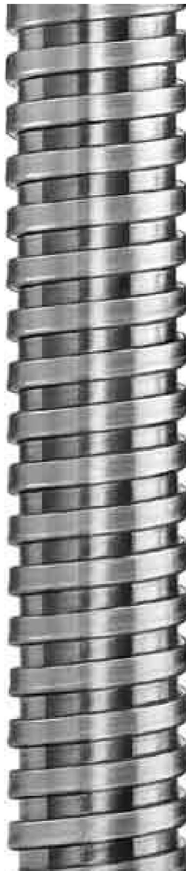
Flexa Metallschutzschlauch Stahl,vz SPR-AS AD10 Nenndurchmesser 10mm, NenngroÙe in Zoll 1/4 Zoll, AuÙendurchmesser 10mm, Innendurchmesser 8mm, Werkstoff Stahl, Oberfläche verzinkt, Ummantlungswerkstoff 1.
