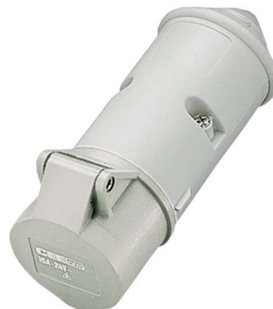
Mennekes Kupplung 16A,2p,12h,50V,IP44 682A IEC-Stromstärke 16A, Polzahl 2, Spannung nach EN 60309-2 40-50 V (50+60 Hz) weiß, Uhrzeit-Stellung 12h, Kennfarbe weiß, Schutzart (IP) IP44, Anschlusstechnik Schraubklemme, Steckrichtung gerade, Kabeleinführung Knickschutzülle, Werkstoff Kunststoff,
