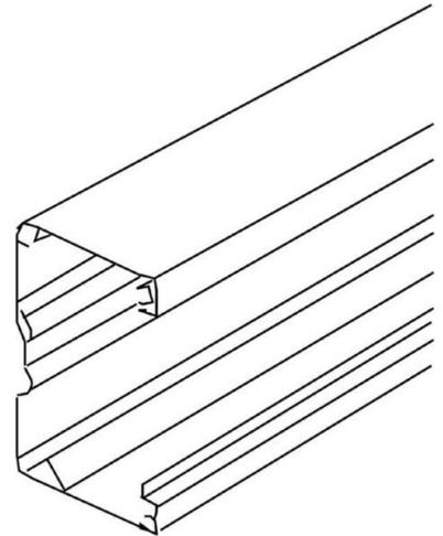
Kleinhuis Kanalunterteil rws Brüstungskanal BU651308.3 Breite 133mm, Tiefe 66mm, Länge 2000mm, Anzahl der Oberteile 1, Oberteilbreite 1 80mm, Symmetrisch, Werkstoff Kunststoff, Werkstoffgüte PVC, Oberfläche unbehandelt, Farbe reinweiß, RAL-Nummer 9010, Ausführung Rückwand (Innenseite) durchlaufendes sonstiges Profil, Anzahl der steckbaren Trennwände 2, Montageart der Oberteile innenliegend, Kanalunterteil aus bleifrei stabilisiertem PVC
