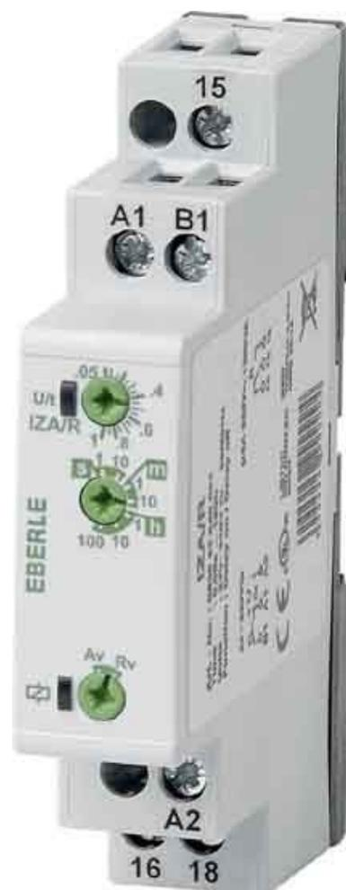
Eberle Controls Zeitrelais 1W,5A,24-240VAC/DC IZA/R Ausführung des elektrischen Anschlusses Schraubanschluss, Funktion ansprechverzögert, Funktion rückfallverzögert, Bemessungssteuerspeisespannung  $U_s$  bei AC 50 Hz 24 ...
