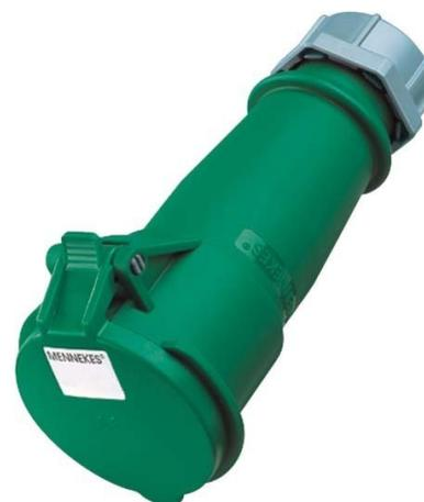
Mennekes Kupplung AM-TOP 32A,4p,2h,>50V 529 IEC-Stromstärke 32A, Polzahl 4, Spannung nach EN 60309-2 50-500 V (>300-500 Hz) grün, Uhrzeit-Stellung 2h, Kennfarbe grün, Schutzart (IP) IP44, Anschlussstechnik Schraubklemme, Steckrichtung gerade, Kabeleinführung Verschraubung, Werkstoff Kunststoff,
