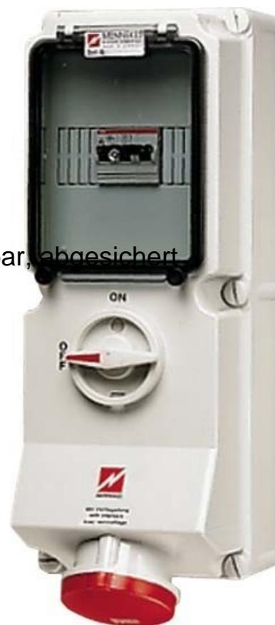
Mennekes Wanddose DUO 32A,5p,6h,400V,IP44 7220 IEC-Stromstärke 32A, Polzahl 5, Spannung nach EN 60309-2 400 V (50+60 Hz) rot, Uhrzeit-Stellung 6h, Kennfarbe rot, Schutzart (IP) IP44, Schalter mechanische Verriegelung, Ausführung des Schalters Sonderschalter, Leerplätze auf Tragschiene, Werkstoff des Gehäuses Kunststoff, Absicherung Automat,
