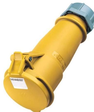
Mennekes Kupplung AM-TOP 32A,3p,4h,110V,IP44 521 IEC-Stromstärke 32A, Polzahl 3, Spannung nach EN 60309-2 110 V (50+60 Hz) gelb, Uhrzeit-Stellung 4h, Kennfarbe gelb, Schutzart (IP) IP44, Anschlussstechnik Schraubklemme, Steckrichtung gerade, Kabeleinführung Verschraubung, Werkstoff Kunststoff,
