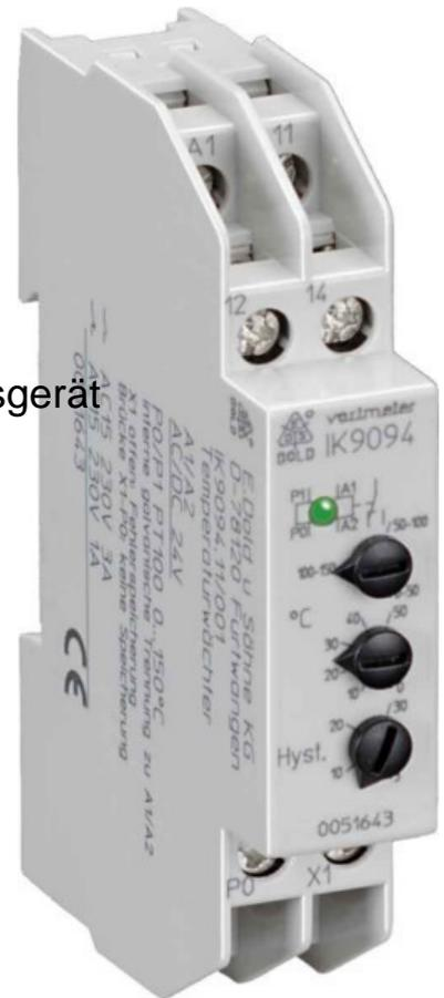
Dold&Söhne Temperaturwächter 0-150C IK9094.11 AC/DC24V Ausführung des elektrischen Anschlusses Schraubanschluss, Bemessungssteuerspeisespannung  $U_s$  bei AC 60 Hz 24 ...
