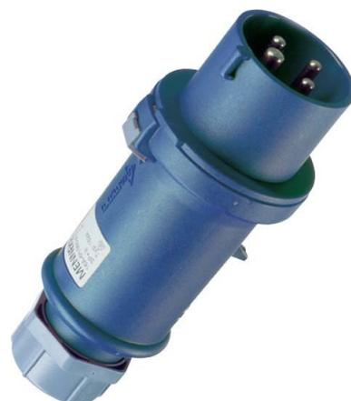
Mennekes Stecker ProTop 16A,4p,9h,230V,II 151A IEC-Stromstärke 16A, Polzahl 4, Spannung nach EN 60309-2 230 V (50+60 Hz) blau, Uhrzeit-Stellung 9h, Kennfarbe blau, Schutzart (IP) IP44, Anschlussstechnik Schraubklemme, Kabeleinführung Verschraubung, Steckrichtung gerade, Werkstoff Kunststoff,
