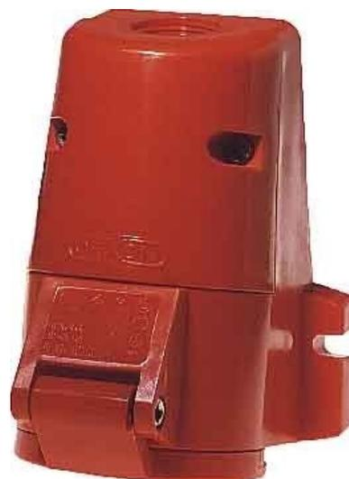
Elektra Tailfingen Cekon-Wandsteckdose CO 432/6H Ausführung Aufputz, IEC-Stromstärke 32A, Polzahl 4, Spannung nach EN 60309-2 400 V (50+60 Hz) rot, Uhrzeit-Stellung 6h, Kennfarbe rot, Schutzart (IP) IPX4, Anschlussstechnik Schraubklemme, Werkstoff Kunststoff, Befestigungsart Außenbefestigung, Isogekapselt
