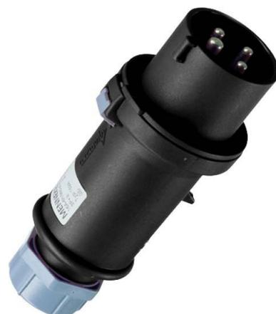
Mennekes Stecker ProTop 32A,4p,7h,500V,II 165 IEC-Stromstärke 32A, Polzahl 4, Spannung nach EN 60309-2 500 V (50+60 Hz) schwarz, Uhrzeit-Stellung 7h, Kennfarbe grün, Schutzart (IP) IP44, Anschlussstechnik Schraubklemme, Kabeleinführung Verschraubung, Steckrichtung gerade, Werkstoff Kunststoff,
