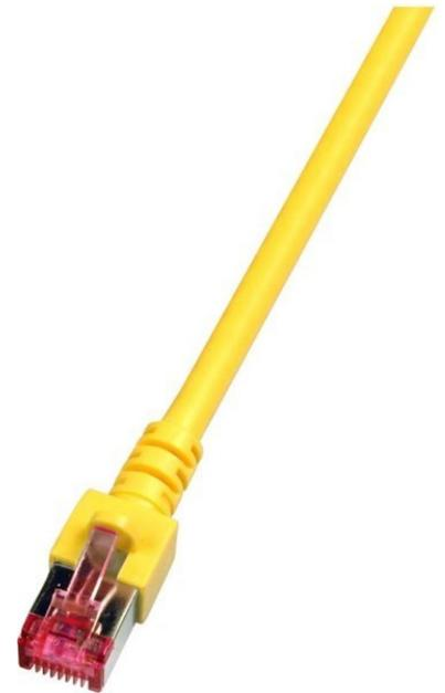
EFB-Elektronik Patchkabel Cat.6 2xRJ45 mit S/FTP EC6000 2m ge S/FTP Kabeltyp S/FTP, Kategorie 6, Länge 2m, Steckverbindertyp Anschluss 1 RJ45 8(8), Steckverbindertyp Anschluss 2 RJ45 8(8), Mantel-Farbe gelb, Knickschutztülle angespritzt, Rasthebelschutz, Farbe der Knickschutztülle gelb, Ausführung flammwidrig, Halogenfrei, Kabelkonstruktion 4x2, AWG-Querschnitt 27, Pinbelegung 1:1, 1 Gigabit Ethernet Cat.6 250 MHz Patchkabel, IEC 60603-7-5.
