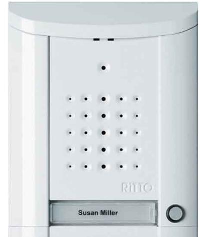
Ritto Türstation ws Entravox, 1Taste 1840170 Anzahl der Ruftasten 1, Montageart Aufputz, Mit Abdeckung, Schutz gegen Vandalismus, Farbe weiß, Installationstechnik Bus-System, Höhe 178mm, Breite 141mm, Tiefe 22mm, Entravox Türstation mit Lautsprecher.
