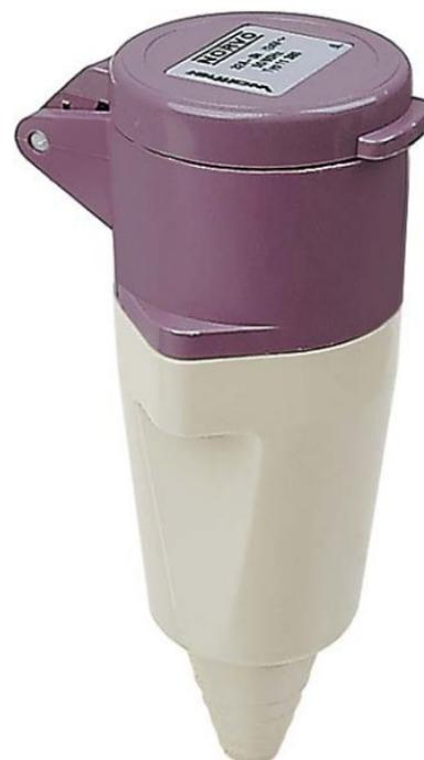
Walther Werke NORVO Kupplung 32A 2P 42V 12h IP44 11381 IEC-Stromstärke 32A, UL/CSA-Stromstärke (wenn UL-Ausführung gewünscht) 30A, Polzahl 2, Spannung nach EN 60309-2 40-50 V (50+60 Hz) weiß, Uhrzeit-Stellung 12h, Kennfarbe weiß, Schutzart (IP) IP44, Anschlussstechnik Schraubklemme, Steckrichtung gerade, Kabeleinführung Knickschutztülle, Werkstoff Kunststoff, NORVO Kupplung 32A 2P 42V 12h IP44 mit Kabelknickschutz
