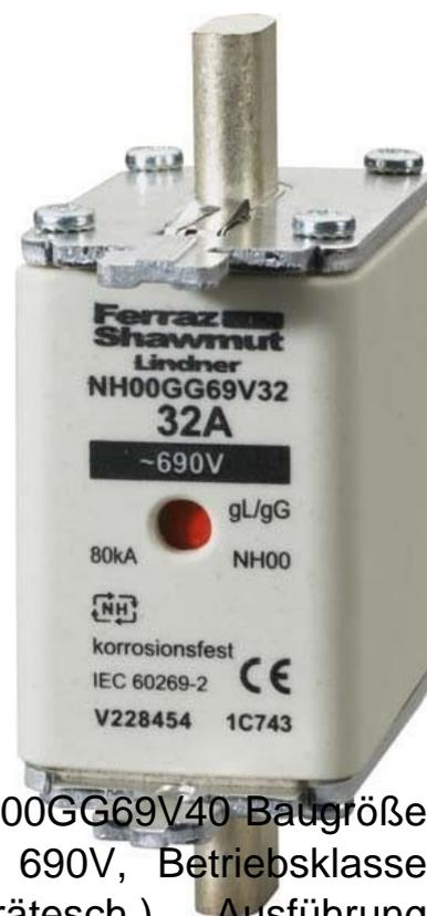
Mersen NH-Sicherungseinsatz Gr.00, 40A, 690V, GG NH00GG69V40 Baugröße NH00, Bemessungsstrom 40A, Bemessungsspannung 690V, Betriebsklasse gL/gG (Ganzbereichs-Leitungsschutz/Ganzbereichs-Gerätesch.), Ausführung Kennmelder Kombikennmelder,
