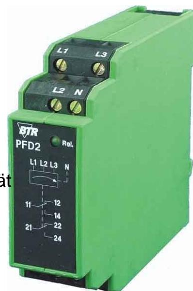
Metz Connect Überwachungsrelais PFD-2-E12 400VAC 2W Ausführung des elektrischen Anschlusses Schraubanschluss, Spannungsart zur Betätigung AC, Funktion Phasenfolgeüberwachung, Funktion Phasenausfallerkennung, Spannungsmessbereich 340 ...
