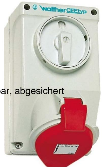
Walther Werke Wandsteckdose 16A 5P 400V 6h IP44 AA110 IEC-Stromstärke 16A, UL/CSA-Stromstärke (wenn UL-Ausführung gewünscht) 20A, Polzahl 5, Spannung nach EN 60309-2 400 V (50+60 Hz) rot, Uhrzeit-Stellung 6h, Kennfarbe rot, Schutzart (IP) IP44, Schalter mit Ein-/Ausschalter ohne Verriegelung, Ausführung des Schalters Sonderschalter, Werkstoff des Gehäuses Kunststoff, Absicherung ohne, Wandsteckdose 16A 5P 400V 6h IP44 Ausschalter 4-polig ohne Verriegelung
