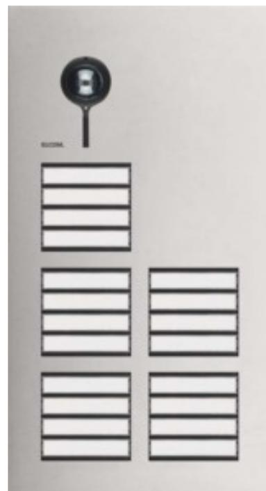
Elcom Türstation-Video 20/2 2D Edelst.ONE REQ520Y Anzahl der Klingeltasten 20, Werkstoff der Klingeltasten Kunststoff, Werkstoff rostfreier Stahl, Montageart Unterputz, Installationstechnik Bus-System, Farbe Silber, Videoerweiterung möglich, Mit Lautsprecher, Mit Kamera, Türstation Video 20/2 2Draht Edelstahl matt ONE.
