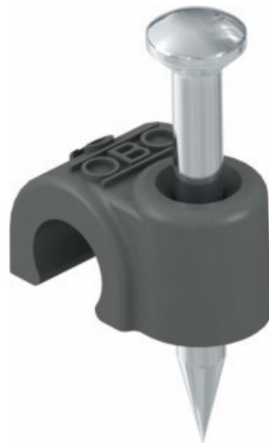
OBO Bettermann Vertr ISO-Nagel-Clip 7mm, L25, tief-sw 2007 25 SW Werkstoff Kunststoff, Farbe schwarz, Nagel mitgeliefert, Nagellänge 25mm, Nageldurchmesser 2mm, Gehärteter Stahlnagel, ISO-Nagel Clip, kurze Bauform
