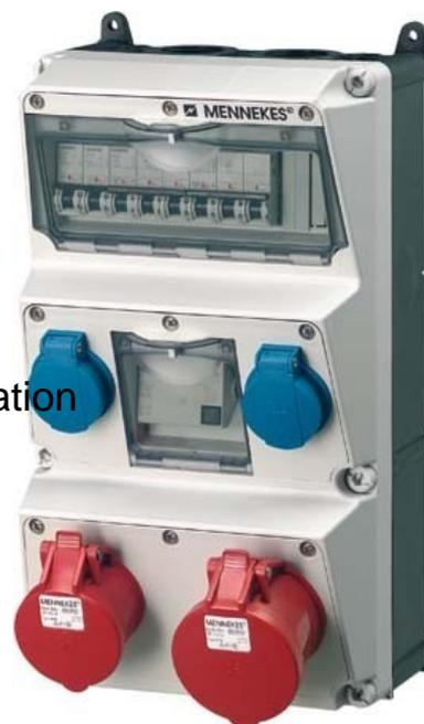
Mennekes Steckdosen-Kombination AMAXX, IP44 930080 CEE-Steckdose - 16 A 1x16A5p400V, CEE-Steckdose - 32 A 1x32A5p400V, CEE-Steckdose - 63 A ohne, CEE-Steckdose - 125A ohne, Anzahl der SCHUKO-Steckdosen 2, Absicherung LS-Schalter, FI-Schutzschalter FI mit IFN 0,03 A (Standard), Werkstoff des Gehäuses Kunststoff, Einspeisung/Anschlussmöglichkeit 1 Leitung (Stichleitung), Art des Netzanschlusses M40, Handhabung Wandmontage, Schutzart (IP) IP44, Farbe grau, Höhe 430mm, Breite 225mm, Tiefe 240mm,
