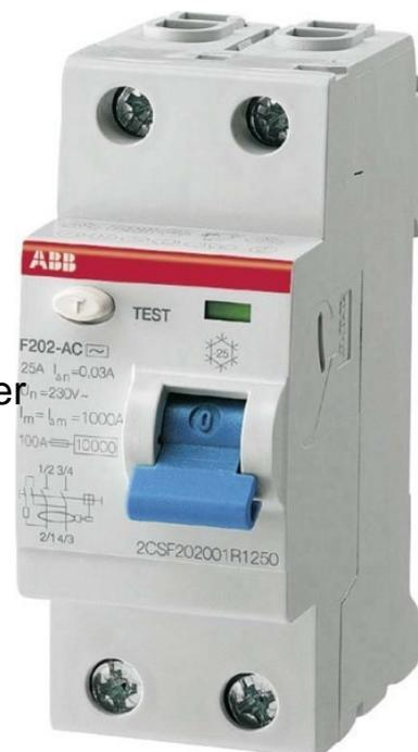
ABB Stotz S&J FI-Schutzschalter 2p, Type F, 63A, 30mA F202F-63/0,03 Polzahl 2, Bemessungsspannung 230V, Bemessungsstrom 63A, Bemessungsfehlerstrom 0,03A, Montageart DIN-Schiene, Fehlerstrom-Typ sonstige, Kurzschlussfestigkeit (Icw) 10kA, Stoßstromfestigkeit 0,25kA, Frequenz 50/60 Hz, Zusatzeinrichtungen möglich, Schutzart (IP) IP20, Breite in Teilungseinheiten 2, Einbautiefe 75,8mm,
