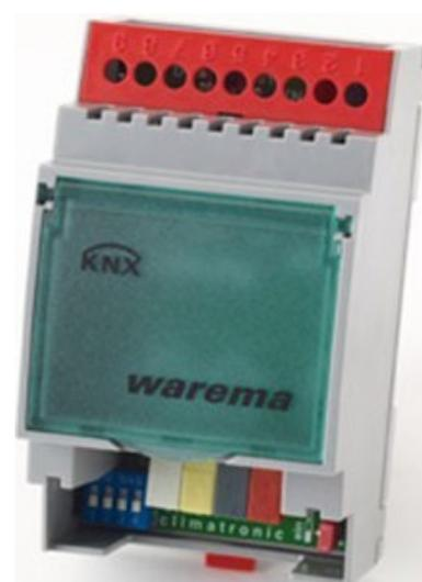
Warema Sonnen KNX Gateway für 16 Kanäle 1002922 Bussystem KNX, Andere Bussysteme sonstige, Montageart REG, Breite in Teilungseinheiten 3, Anzahl der Anschlüsse Sensor/Aktor 0, Befestigungsart sonstige, Für den Einsatz der WAREMA climatronic als Zentrale in einem KNX-Bussystem, sendet Fahrbefehle, Wetterdaten und Zustandsinformationen der WAREMA climatronic auf den KNX-Bus.
