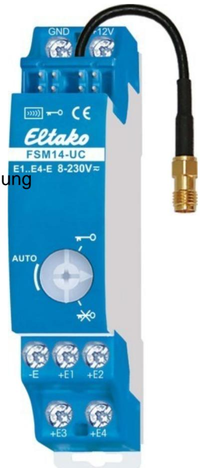
Eltako Funk-Sendemodul 4-fach FSM14-UC Bussystem Funkbus, Andere Bussysteme ohne, Montageart REG, Breite in Teilungseinheiten 1, Anzahl der Betätigungspunkte 4, Befestigungsart Klemmbefestigung, Schutzart (IP) IP20, Funk-4-fach-Sendemodul, mit austauschbarer Antenne, zum Senden von Funktelegrammen in den Eltako-Gebäudefunk, zum Anschluß von 4 Tasteinheiten, Versorgungsspannung 12V DC.
