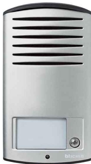
Legrand (SEKO) AP-Türstation alu Audio 342911 Mit Infoschild, Anzahl der Ruftasten 1, Montageart Aufputz, Mit Abdeckung, Farbe sonstige, Installationstechnik Bus-System, Höhe 176mm, Breite 98mm, Tiefe 31mm, Aufputz-Türstation linea 2000 mit 1 Ruftaste, 2-Draht-Bussystem Anschluss mit Anschlussklemmen für Busleitung und Türöffner, zwei Regler zum einstellen der Sprechlautstärke, LED-Beleuchtung für Namensschilder
