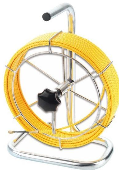
Cimco Stahl-Haspel f.Kati-Twist 20m 14 2550 Einsatzbereich Installationsrohr, Werkstoff Kunststoff, Werkstoffgüte Polyamid (PA), Länge 20m, Breite/Durchmesser des Einziehdrahts 5,2mm, Materialstärke des Einziehdrahts 5,2mm, Kopfform sonstige, Stahl-Haspel Kati Twist, inklusive 1 Federführungskopf Ø 10 mm, 1 Messing-Zugkopf mit Öse Ø 6 mm (Gewinde M5), 2 Messing-Anfangshülsen (Gewinde M5), Ø 5,2 mm Länge 20 m
