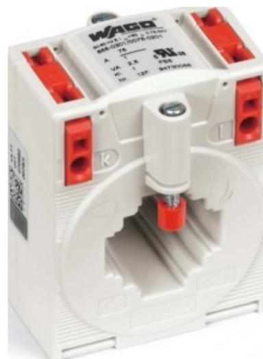
WAGO Kontakttechnik Aufsteck-Stromwandler 150A/5A 855-305/150-501 Ausführung Aufsteckstromwandler, Primärer Bemessungsstrom In 150A, Sekundärer Bemessungsstrom 5A, Sekundäre Bemessungsscheinleistung 5VA, Genauigkeitsklasse 1, Überstrombegrenzungsfaktor FS 5, Mit Berührungsschutz, Öffnungshöhe 25,3mm, Öffnungsbreite 25,3mm, Öffnungsdurchmesser 25,7mm, Schnappbefestigung, Sekundäranschluss Steckanschluss, Anzahl der Primäreingänge 1,
