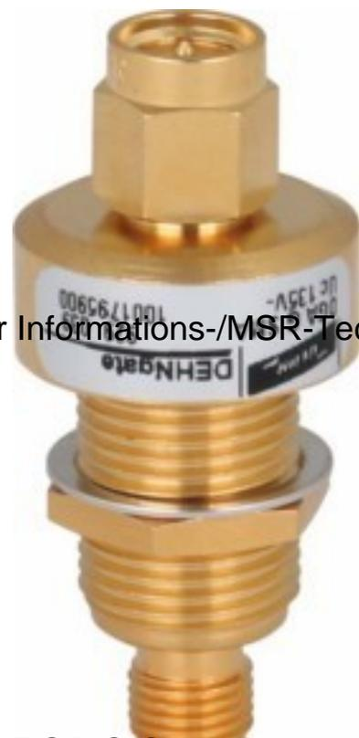
Dehn+Söhne Überspannungsableiter mit SMA Anschluss DGA G SMA Höchste Dauerspannung DC 135V, Nennableitstoßstrom (8/20) 5kA, Nennlaststrom 2A, Schutzpegel Ader/Signalground 700V, Frequenz 0 ...
