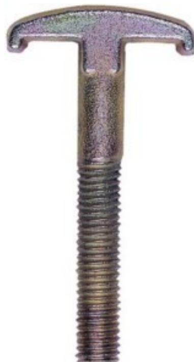
Striebel&John Hakenkopf-Schraube M10x70mm ZX199P10(VE10) Werkstoff Stahl, Oberfläche galvanisch/elektrolytisch verzinkt, Gewindemaß metrisch 10, Länge 70mm,
