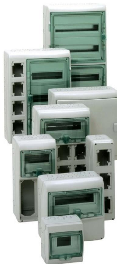
Schneider Electric Universalgehäuse 12TE H=335mm 13166 Montageart Aufbau, Anzahl der Reihen 1, Breite in Teilungseinheiten 12, Ausführung Deckel geschlossen, Transparenter Deckel/Tür, Werkstoff des Gehäuses Kunststoff, Höhe 335mm, Breite 340mm, Tiefe 160mm, DIN-Schiene, Farbe grau, RAL-Nummer 7035, Schutzart (IP) IP65,
