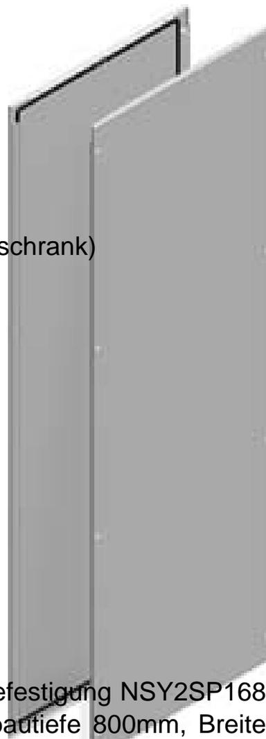
Schneider Electric Seitenwand SF 1600x800mm Außenbefestigung NSY2SP168 (VE2) Geeignet als Seitenwand, Geeignet für Gehäusebautiefe 800mm, Breite 800mm, Höhe 1600mm, Werkstoff Stahl, Ausführung der Oberfläche pulverbeschichtet, Farbe grau, RAL-Nummer 7035,
