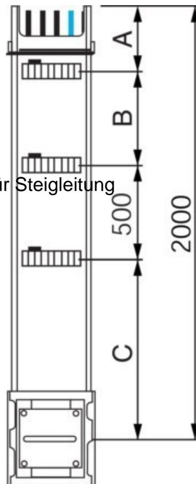
Schneider Electric Verteilerstreckenstück 2m, 250A KSA250EV4203 Polzahl 5, Anzahl der Leiter (ohne Erde) 4, Bemessungsstrom bei AC 50 Hz 250A, Bemessungsspannung bei AC 50 Hz 230 ...
