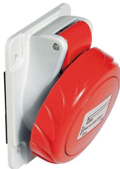
Schneider Electric Industriesteckdose gewinkelt, 16A, 3p+E PKF16F734 IEC-Stromstärke 16A, Polzahl 3, Spannung nach EN 60309-2 400 V (50+60 Hz) rot, Uhrzeit-Stellung 6h, Kennfarbe rot, Schutzart (IP) IP67, Anschlussstechnik Schraubklemme, Steckrichtung abgewinkelt, Werkstoff Kunststoff, Flanschmaß vertikal 85mm, Bohrlochabstand vertikal 60mm, Flanschmaß horizontal 65mm, Bohrlochabstand horizontal 52mm,
