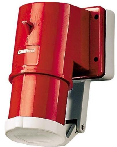
Mennekes Aufbaustecker 16A,5p,6h,400V,IP44 400 IEC-Stromstärke 16A, Polzahl 5, Spannung nach EN 60309-2 400 V (50+60 Hz) rot, Uhrzeit-Stellung 6h, Kennfarbe rot, Schutzart (IP) IP44, Anschlussstechnik Schraubklemme, Bauform Aufbaugerätestecker, Steckrichtung rechtwinklig, Werkstoff Kunststoff, Mit Klappdeckel
