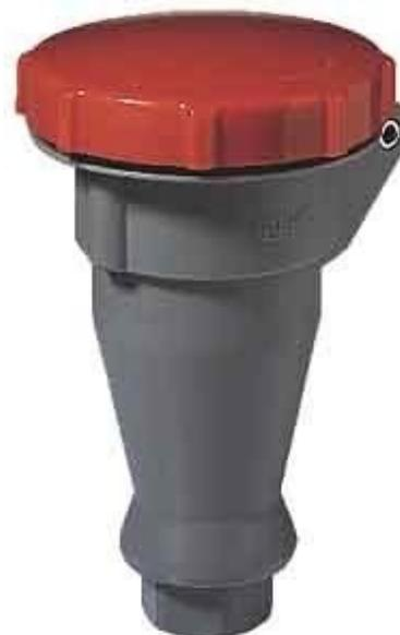
Elektra Tailfingen Cekon-Kupplungsdose CCW 416/6H IEC-Stromstärke 16A, Polzahl 4, Spannung nach EN 60309-2 400 V (50+60 Hz) rot, Uhrzeit-Stellung 6h, Kennfarbe rot, Schutzart (IP) IPX7, Anschlussstechnik Schraubklemme, Steckrichtung gerade, Kabeleinführung Verschraubung, Werkstoff Kunststoff, Isogekapselt
