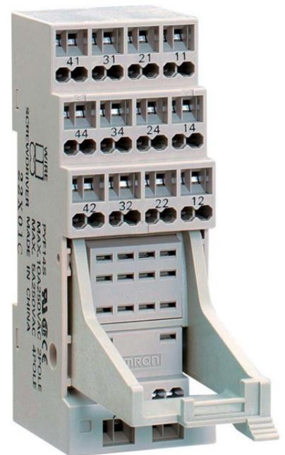
Omron Relaissockel PYF14SBYOMZ Ausführung des elektrischen Anschlusses Federzuganschluss, Montageart Hutschiene 35 mm, Anzahl der Pins 14, Breite 31mm, Höhe 85mm, Tiefe 36mm,
