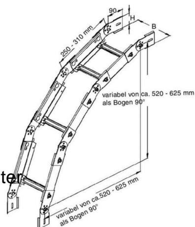
Niedax Verstellbarer Bogen KGS 60.603 F Ausführung des Seitenholms flaches Profil, Ausführung der Sprosse Profil ungelocht, Abbiegung (Winkel) 90°, Scharnierend, Kabelleiterhöhe 60mm, Kabelleiterbreite 600mm, Innenradius 625mm, Werkstoff Stahl, Werkstoffgüte sonstige, Oberfläche tauchfeuerverzinkt, Farbe ohne, Kompletter Bausatz für steigende und fallende Montage, Lieferung: unmontiert
