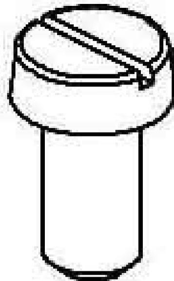
Niedax Schraube Z M6X30 Werkstoff Stahl, Werkstoffgüte 4.8 (Stahl), Oberfläche galvanisch/elektrolytisch verzinkt, Kopfform Zylinderkopf, Gewindemaß metrisch 6, Länge 30mm, Schraubensystem Schraubenschlitz, Zylinderkopfschraube mit Schlitz, DIN 84
