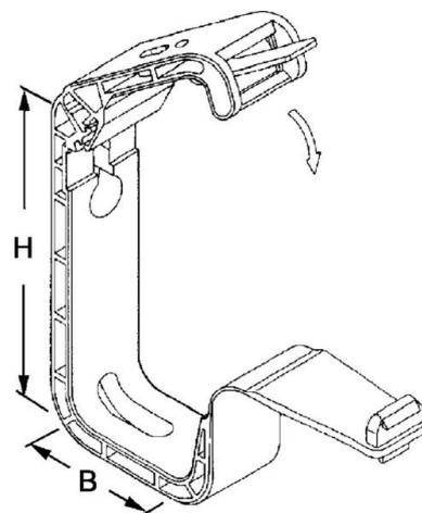
Niedax Sammelhalter SHF 30 Für Anzahl Leitungen NYM 3x1,5 30, Werkstoff Kunststoff, Oberfläche unbehandelt, Farbe lichtgrau, Ausführung flammwidrig, Halogenfrei, flammwidrig (VDE 0471-960° und UL 94V2), PP weiß
