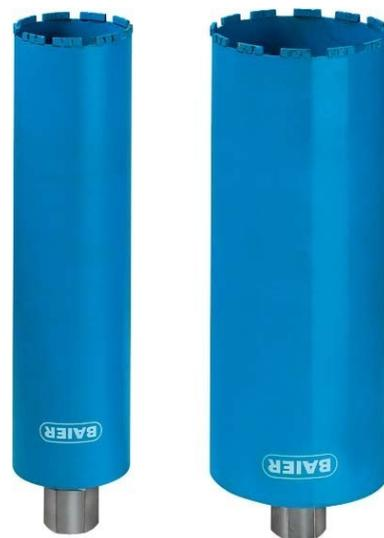
Baier Maschinenfabrik Bohrkronen Eco Diamant-Nass 59220 Nennmaß 82mm, Aufnahmesystem Gewindeaufnahme, Arbeitstiefe 400mm, Beschichtung Diamant, Geeignet für Nassbetrieb, Diamantnassbohrkronen Premium, mit Gewindeaufnahme 1 1/4 Zoll, Einsatzgebiet Beton, Beton armiert, Klinker
