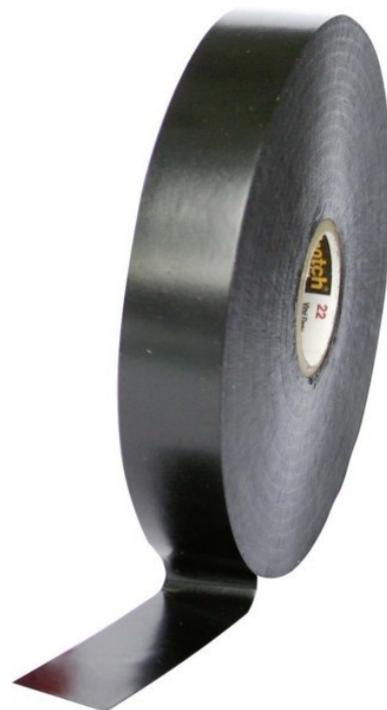
3M Deutschland PVC Elektro-Isolierband 50 mm x 33 m, Vynil Scotc 22 50x33 sw Breite 50mm, Werkstoff PVC, Farbe schwarz, Länge 33m, UV-beständig, Isolierend, Selbstverlöschend, Stärke 0,25mm, Selbstklebend.
