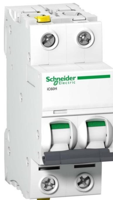
Schneider Electric LS-Schalter 2P 16A C IC60H A9F07216 Auslösecharakteristik C, Polzahl (gesamt) 2, Anzahl der abgesicherten Pole 2, Bemessungsstrom 16A, Bemessungsspannung 230V, Spannungsart AC, Frequenz 50 ...
