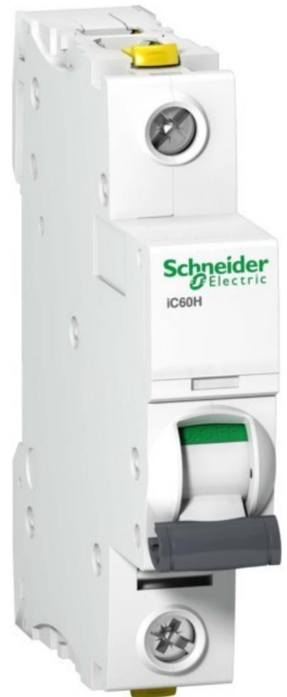
Schneider Electric LS-Schalter 1P 10A C IC60H A9F07110 Auslösecharakteristik C, Polzahl (gesamt) 1, Anzahl der abgesicherten Pole 1, Bemessungsstrom 10A, Bemessungsspannung 230V, Spannungsart AC, Frequenz 50 ...
