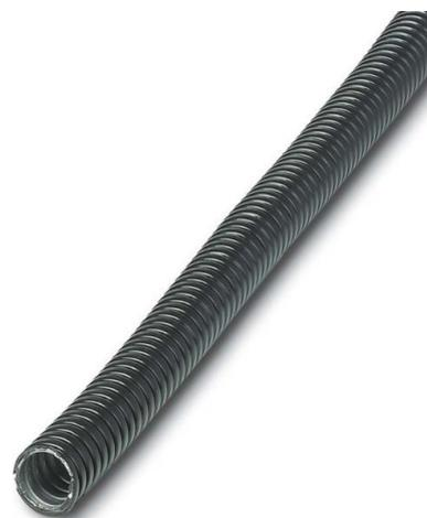
Phoenix Contact Schutzschlauch WP-STEEL PVC C 36 Außendurchmesser 36mm, Innendurchmesser 29mm, Werkstoff Stahl, Oberfläche verzinkt, Einsatztemperatur -25 ...
