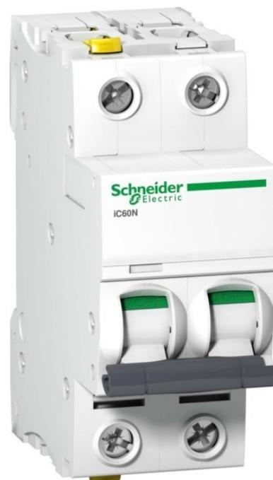
Schneider Electric LS-Schalter 2P 25A B IC60N A9F03225 Auslösecharakteristik B, Polzahl (gesamt) 2, Anzahl der abgesicherten Pole 2, Bemessungsstrom 25A, Bemessungsspannung 400V, Spannungsart AC, Frequenz 50 ...
