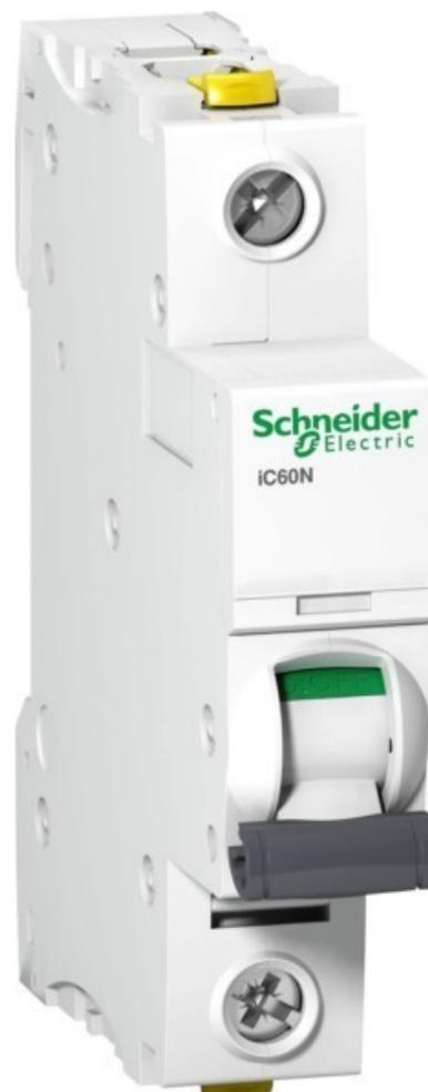
Schneider Electric LS-Schalter 1P 40A B IC60N A9F03140 Auslösecharakteristik B, Polzahl (gesamt) 1, Anzahl der abgesicherten Pole 1, Bemessungsstrom 40A, Bemessungsspannung 230V, Spannungsart AC, Frequenz 50 ...
