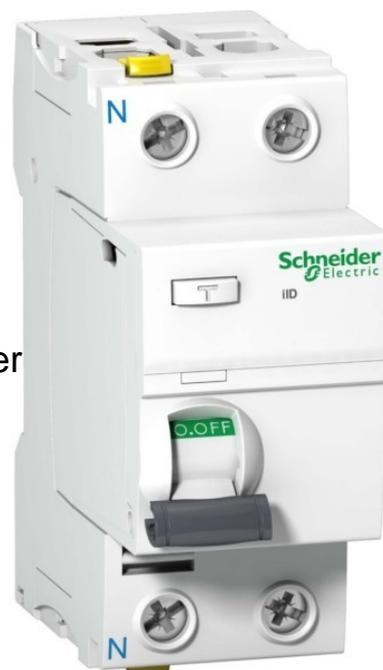
Schneider Electric FI-Schalter 2P 40A 300mA Typ A A9Z24240 Polzahl 2, Bemessungsspannung 230V, Bemessungsstrom 40A, Bemessungsfehlerstrom 0,3A, Montageart DIN-Schiene, Fehlerstrom-Typ A, Zusatzeinrichtungen möglich, Breite in Teilungseinheiten 2, Mit Doppel-Anschlussklemme für Stift-Phasenschiene und Kabel, Frontseitige Fehlermeldeanzeige, Vorneliegendes Befestigungselement, für Hilfsschaltermontage linksseitig
