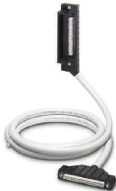
Phoenix Contact Systemkabel und Zubehör FLK 50-PA/E #2314312 Funktion SPS-sonstige Geräte, Länge 4m, Geeignet für digitale Signale, Ausführung elektrischer Anschluss, feldseitig sonstige, Ausführung elektrischer Anschluss, gehäuseseitig sonstige, Polzahl 50, Konfektioniertes Rundkabel mit zwei umspritzten 50-poligen Federleisten (1:1 Verbindung)
