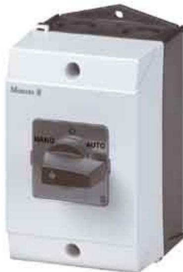
Eaton (Moeller) Ein-Aus-Schalter I(G) T3-2-8211/I2 Ausführung Umschalter, Polzahl 2, Mit Nullstellung, Bemessungsdauerstrom I<sub>u</sub> 32A, Bemessungsbetriebsleistung bei AC-3, 400 V 13kW, Schutzart (IP), frontseitig IP65, Anzahl der Hilfskontakte als Öffner 0, Anzahl der Hilfskontakte als Schließer 0, Anzahl der Hilfskontakte als Wechsler 0, Geeignet für Bodenbefestigung, Komplettgerät im Gehäuse, Ausführung des Betätigungselements Knebel, Anschlussart Hauptstromkreis Schraubanschluss,
