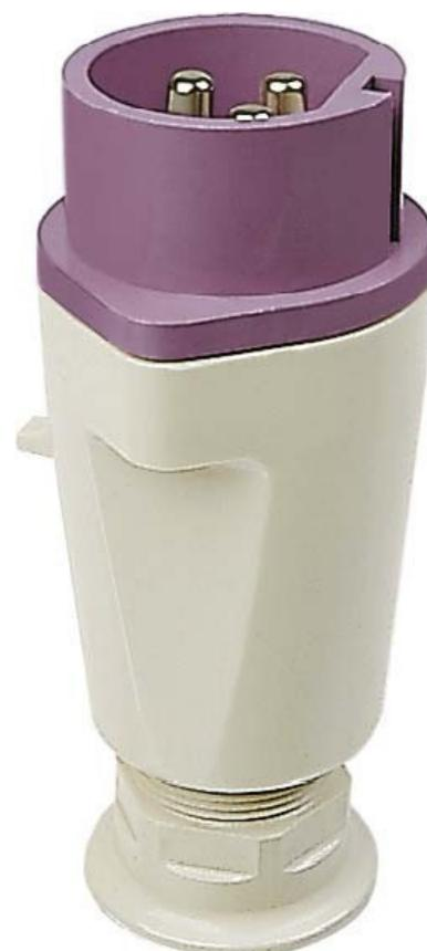
Walther Werke NORVO Stecker 32A 3P 24V 0h IP44 11260 IEC-Stromstärke 32A, UL/CSA-Stromstärke (wenn UL-Ausführung gewünscht) 30A, Polzahl 3, Spannung nach EN 60309-2 20-25 V (50+60 Hz) violett, Uhrzeit-Stellung 0h, Kennfarbe lila/violett, Schutzart (IP) IP44, Anschlussstechnik Schraubklemme, Kabeleinführung Verschraubung, Steckrichtung gerade, Werkstoff Kunststoff, NORVO Stecker 32A 3P 24V IP44 mit Trompeten- verschraubung
