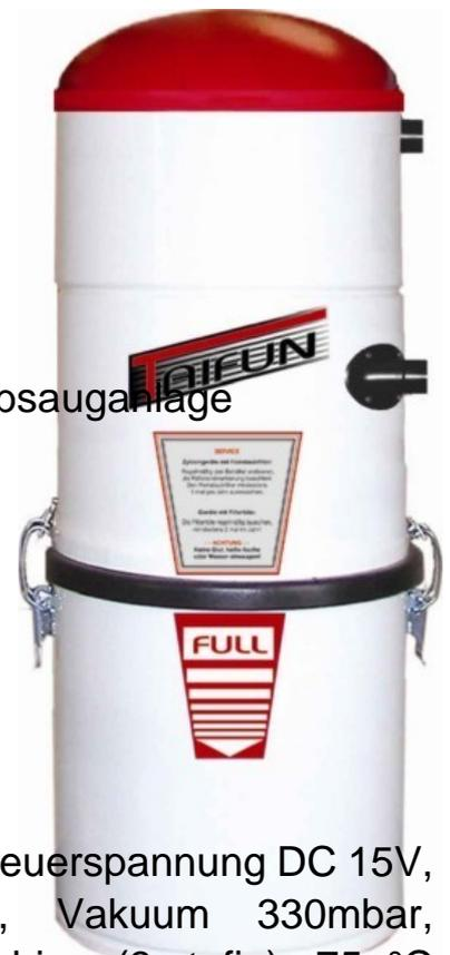
Herz Zentralsauger CP-Taifun Betriebsspannung 230V, Steuerspannung DC 15V, Leistungsaufnahme 1800W, Luftleistung 580AirWatt, Vakuum 330mbar, Luftmenge 175m<sup>3</sup>/h, Mit Kartuschenfilter, Tangentialturbine (3-stufig), 75 °C Thermoschutz reversibel, ca.
